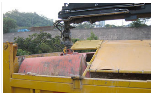
在夾斗車裝設經改良的「加翼」蓋掩，可減少塵埃散溢。
