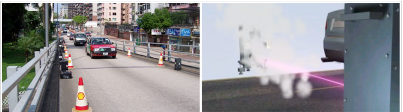
路邊遙測設備進行偵測車輛排放的測試。
